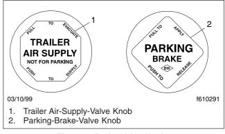
Fig. 13.2, Brake Valve Knobs
