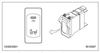
Fig. 10.1, Air-Suspension Dump Valve
