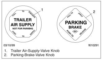
Fig. 9.3, Brake Valve Knobs
